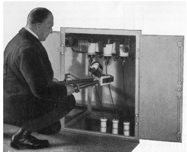
Bild 6: Strommessung mit Dietze-Anleger
