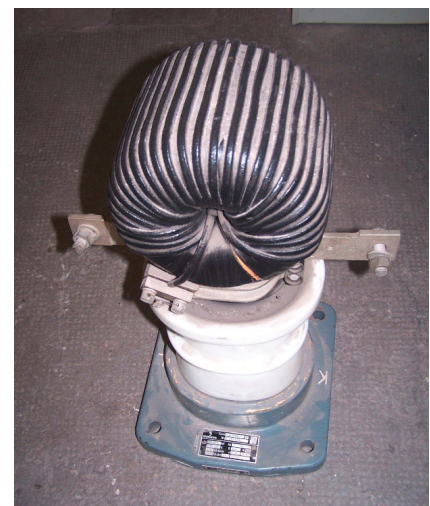
Bild 17: Stromwandler A20P1, SSW, 1925
